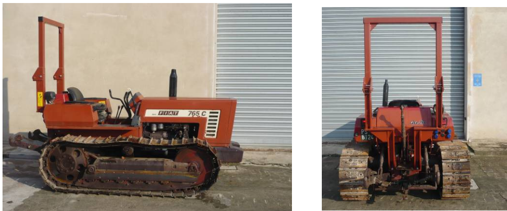
Figura 13. Struttura di protezione per trattori a cingoli modello Fiat 765 C e simili (Fiat 665 CM)
