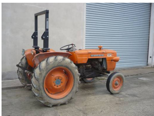
Figura 14. Struttura di protezione per trattori a ruote a carreggiata standard modello Fiat 415R e simili
