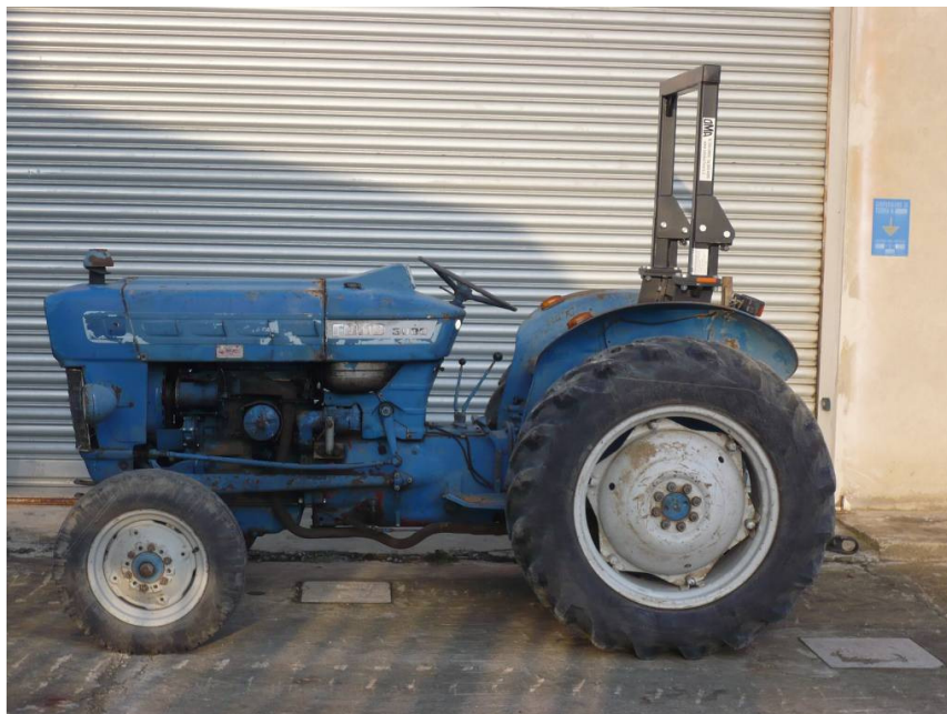
Figura 10. Struttura di protezione per trattori a ruote a carreggiata standard modello Ford Super Dexta 3000
