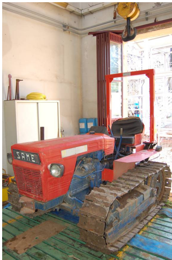
Figura 12. Struttura di protezione per trattori a cingoli modello Same Falcon C e simili
