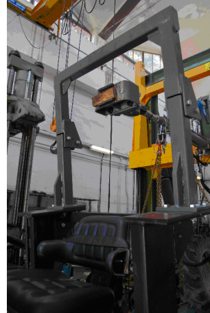
Figura 12. Struttura di protezione per trattori a ruote modello Fiat 640 e simili
