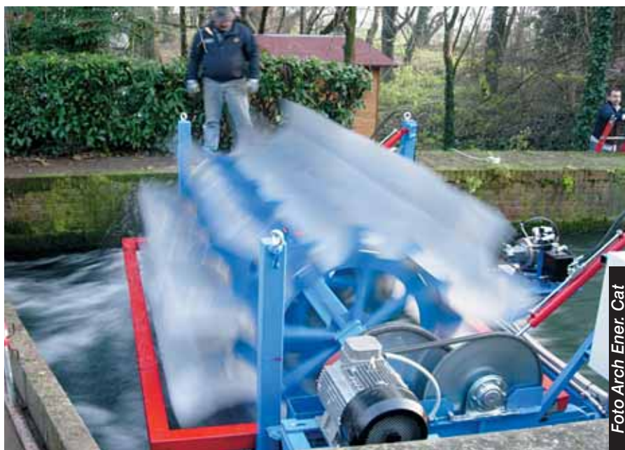
Foto 3 L'impianto sperimentale (ruota da 3 metri) della Ener.Cat, installato presso Genivolta (CR).
