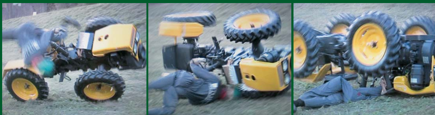
Ribaltamento della trattrice con operatore non trattenuto al posto di guida.
