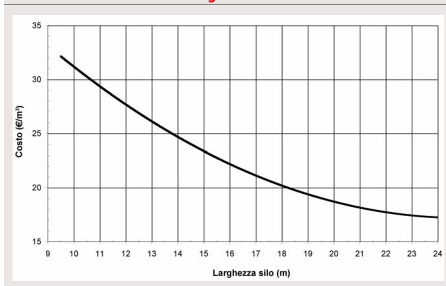
Graf. 1 – Silo singolo: andamento del costo di costruzione unitario al variare della larghezza effettiva del silo.
