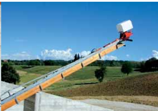
Elevatore fisso con sistema di trasporto a catena e palette a moto continuo.
